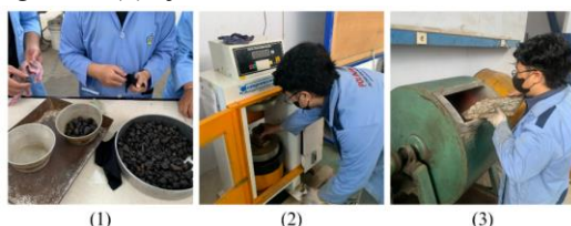
Gambar 4. Pengujian sifat fisik Agregat Kasar
