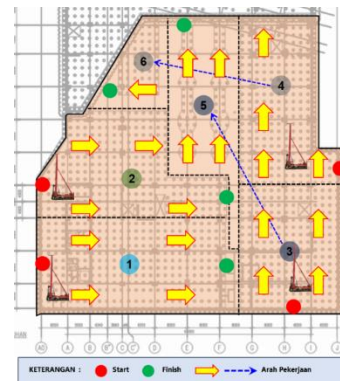
Gambar 6. Zonasi Pekerjaan Pondasi Spun Pile
