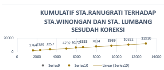
Gambar 3 Uji konsistensi Sta.Ranugrati terhadap Sta.Winongan dan Lumbang setelah koreksi. Pada grafik tersebut setelah dilakukan koreksi data terlihat bahwa tidak ada patahan atau konsisten.
