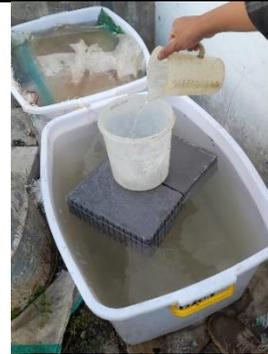
**Gambar 9** Pengujian 2 Beton Apung
