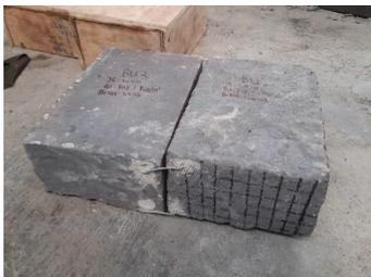
**Gambar 8** Penyambungan 2 Benda Uji
