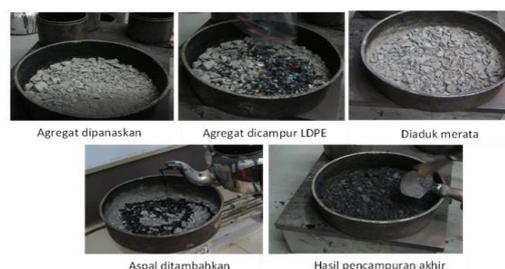
**Gambar 2** Proses Pencampuran Cara Kering
