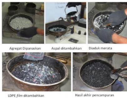
Gambar 3 Proses Pencampuran Cara Basah
