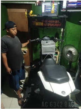
Gambar 1. Setting Peralatan Pengujian pada Dyno
