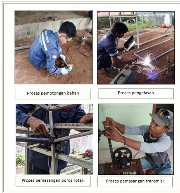
Gambar 6. Dokumentasi Proses Pembuatan dan Perakitan Mesin
