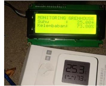
GAMBAR 3.2 PERBANDINGAN PENGUKURAN SUHU DAN KELEMBABAN MENGGUNAKAN ALAT DENGAN TERMOMETER DIGITAL
