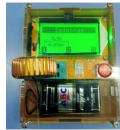
GAMBAR 3.4 HASIL PENGUJIAN INDUKTOR 1 MENGGUNAKAN LCR METER
