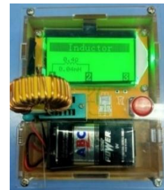
GAMBAR 3.5 HASIL PENGUJIAN INDUKTOR 2 MENGGUNAKAN LCR METER
