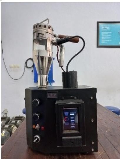
GAMBAR 3.1 ALAT ROASTING BIJI KOPI ELEKTRIK BERBASIS FLUIDIZED BED
