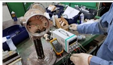
GAMBAR 2.3 PENGUKURAN *TRANSMITTER* MENGGUNAKAN MULTIMETER DIGITAL
