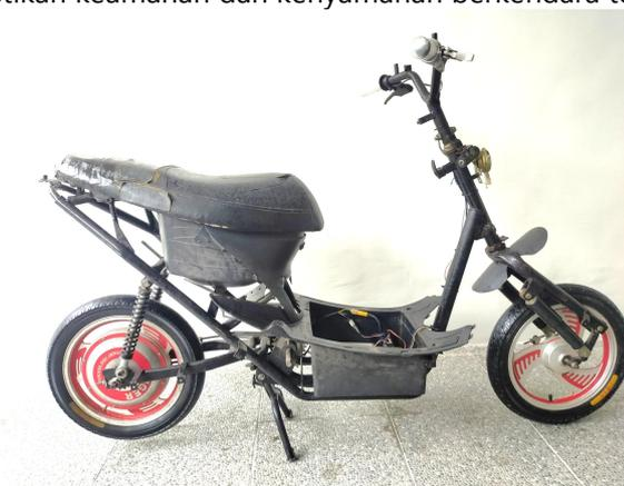
Gambar 2. Perancangan Rangka Motor
