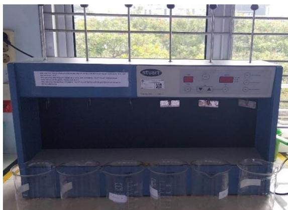
**Gambar 2.** Rangkaian peralatan *jar test*
