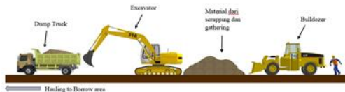
Gambar 5. Ilustrasi Pekerjaan Galian Tanah Inlet
